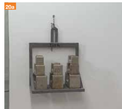
20a. L'applicazione dei carichi può avvenire immediatamente in qualsiasi punto e con qualsiasi sistema di fissaggio.
