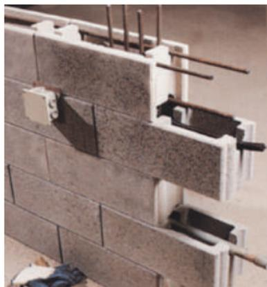
Utilizzando il blocco SOLI-STA si possono realizzare muri attrezzati grazie alle spaziature degli incastri orizzontali studiate per il passaggio degli impianti idrici ed elettrici e per la posa di eventuali ferri di armatura. Il muro viene poi reso portante con il riempimento di calcestruzzo.
