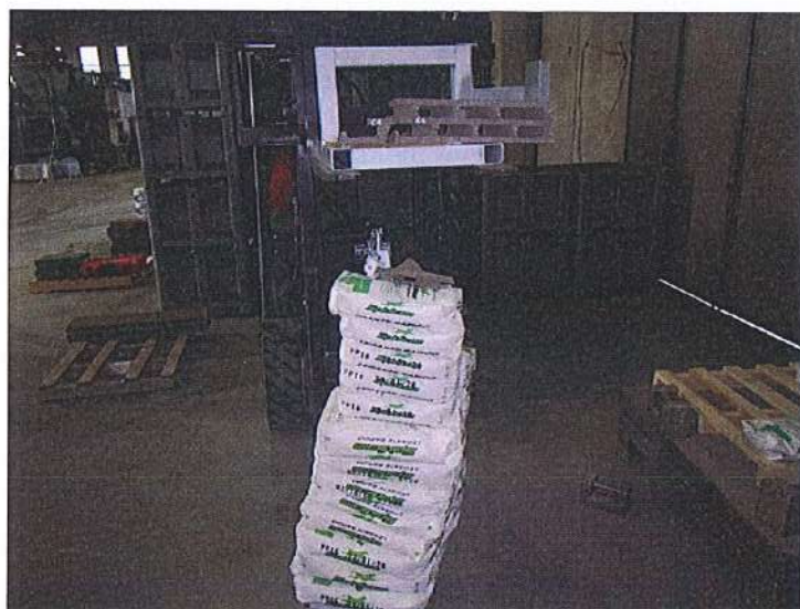
Fotografie di alcuni pannelli durante la prova di taglio
