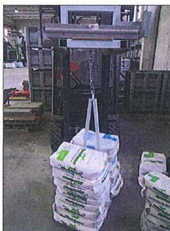
Fotografie di alcuni pannelli durante la prova di estrazione
