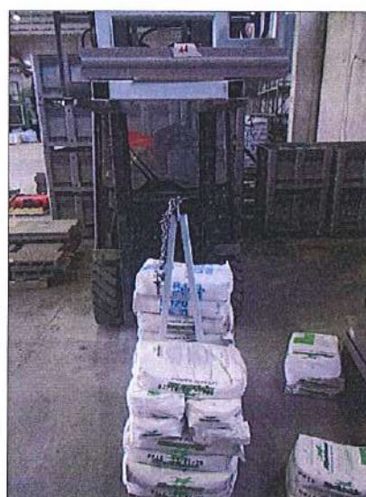
Fotografie di alcuni pannelli durante la prova di taglio
