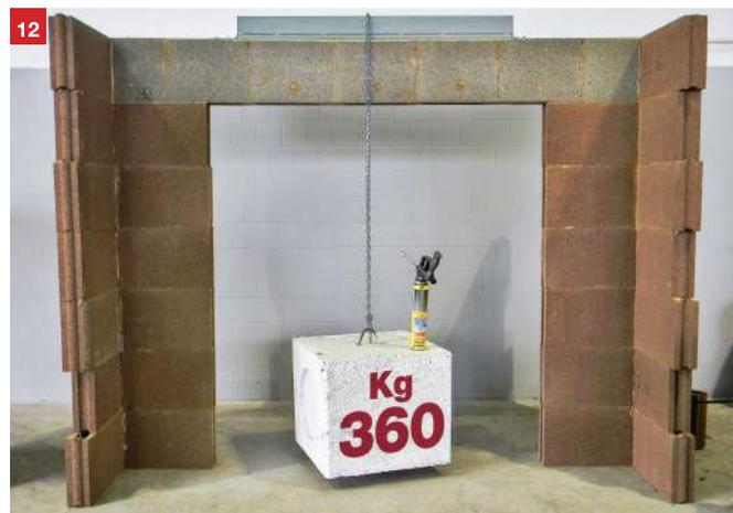
Esempio di architrave grande apertura di cm 160 con il carico appeso di 360 Kg (foto 12).
