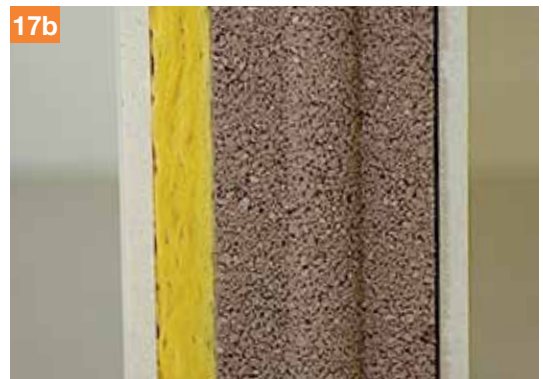
17b. Soluzione con lastra accoppiata con lana minerale e lastra standard per ottenere valori di 50 dB ed EI 180.
